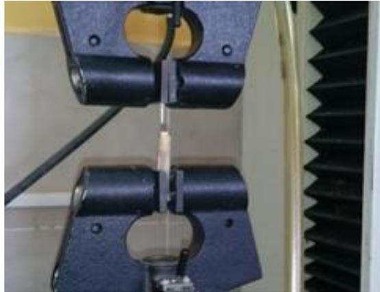
Todas las muestras fueron colocadas en la maquina universal de ensayos mecánicos (Instron 1011) como se muestra en la (Figura 1), siendo sujetadas por presión al igual que el perno que fue tomado directamente para conseguir datos más precisos con una separación de las mordazas de 27.80 mm, el estudio se realizó aplicando fuerzas de deformación en un sentido, traccionando con una velocidad de 150 mm/min, con una temperatura de ensayo de 18 °C.
